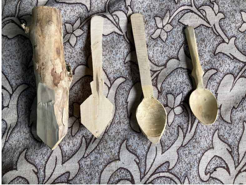
Fotoğraf 4. Yüksel Ustanın Yapmış Olduğı Oyun Kaşığının Aşamaları
